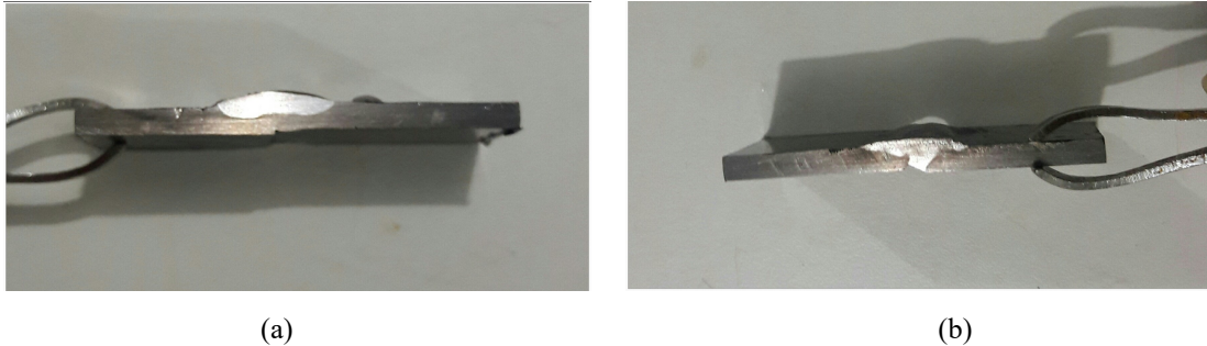
Figura 26 – Macrografia dos corpos de prova soldados com eletrodo revestido: (a) sem abertura da junta; (b) com abertura da junta de 1,25 mm
